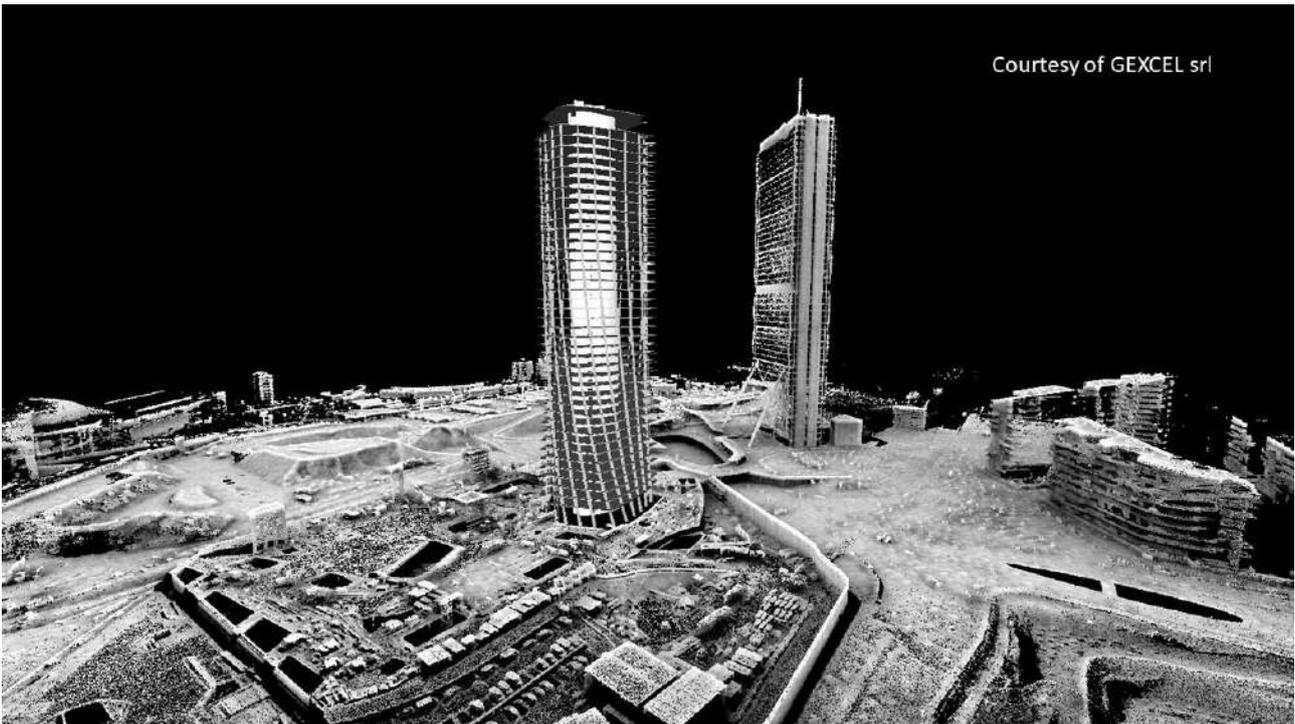
*Figura 1 Rilevamento del cantiere Milano CityLife con laser scanner statico (Courtesy of GEXCEL srl)*
