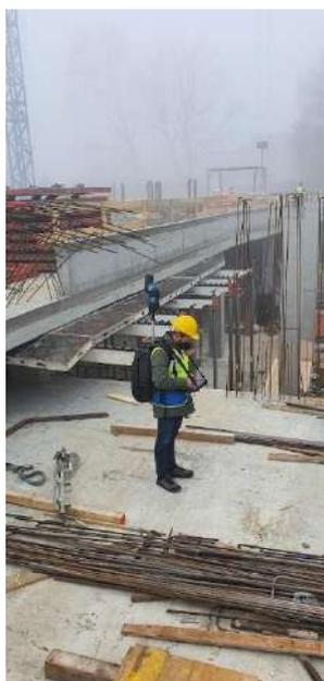
*Figura 16 - Esempio di rilevamento sul campo con sistema di mobile mapping*
