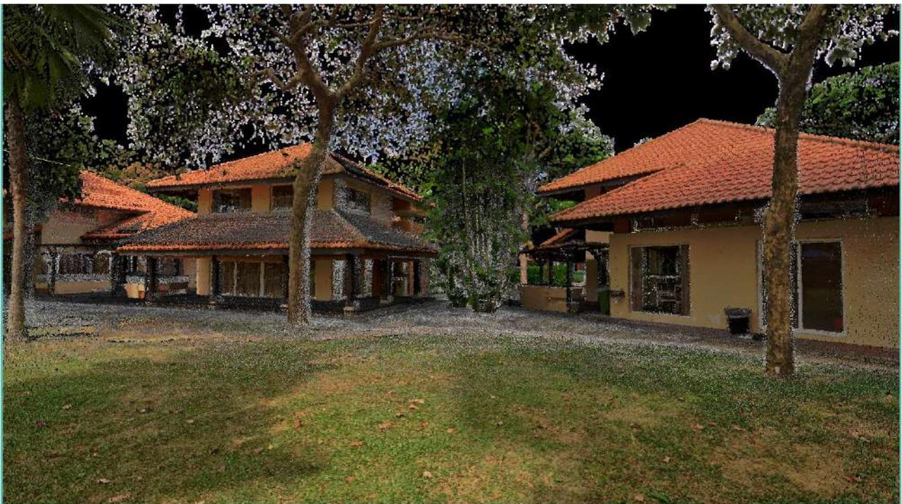
*Figura 3 Esempio di rilevamento di edifici effettuata con sensore statico Faro Focus e colorazione della nuvola di punti tramite la camera integrata con lo strumento*
