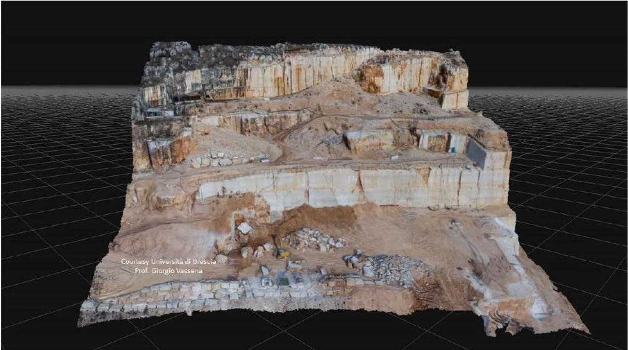
*Figura 8 - Il rilevamento di una cava presso il Comune di Botticino (Brescia), tramite acquisizioni fotografiche da SAPR – (Università di Brescia)*
