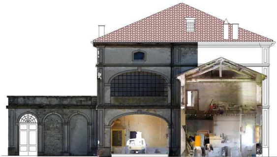
Fig.5: Restituzione CAD ed ortofoto colorata ad alta risoluzione
