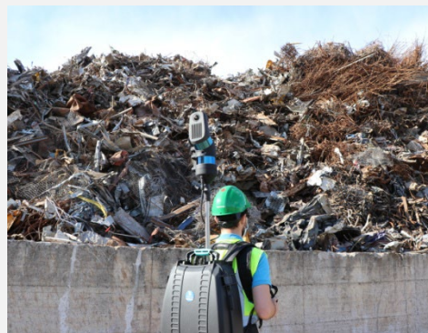
Fig1_ Fase di rilievo con HERON MS Twin di un cumulo di rottame all'interno dello stabilimento.
